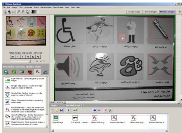
شکل ۴: ردیابی نقطه لیزری و سه شکل گوشه
